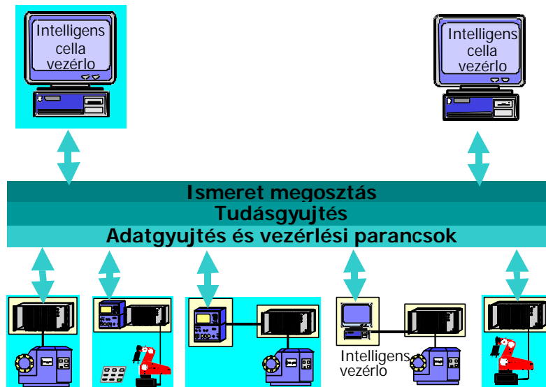
1. ábra Az intelligens kommunikáció logikai szintjei gyártórendszerekben [9]
